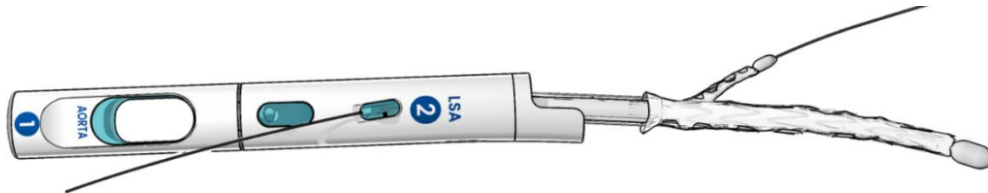
Figura 9. Inserimento di un filo guida LSA attraverso il lume di accesso del ramo di rilascio Arcevo™ LSA
